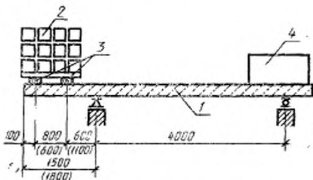
1 — испытываемая плита; 2 — нагрузки на всю ширину плиты; 3 — деревянные брусья сечением 10×10 см; 4 — пригрузочный балласт
