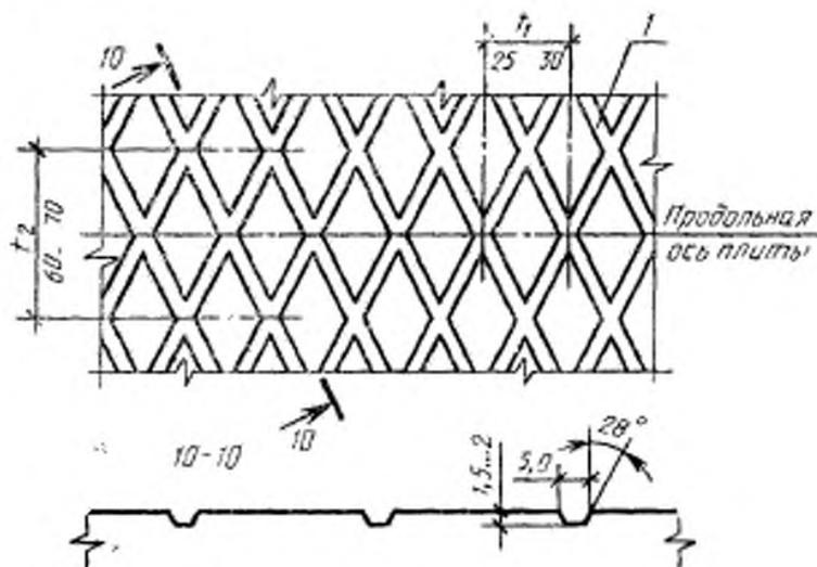
1 — рифление рабочей поверхности плиты
